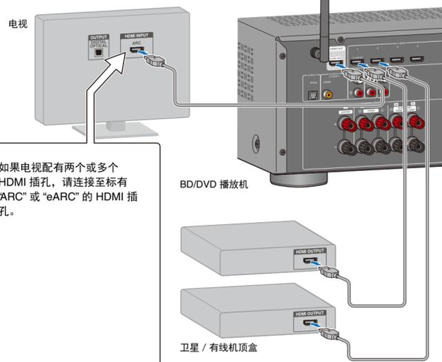
如果电视配有两个或多个 HDMI 插孔，请连接至标有“ARC”或“eARC”的 HDMI 插孔。
